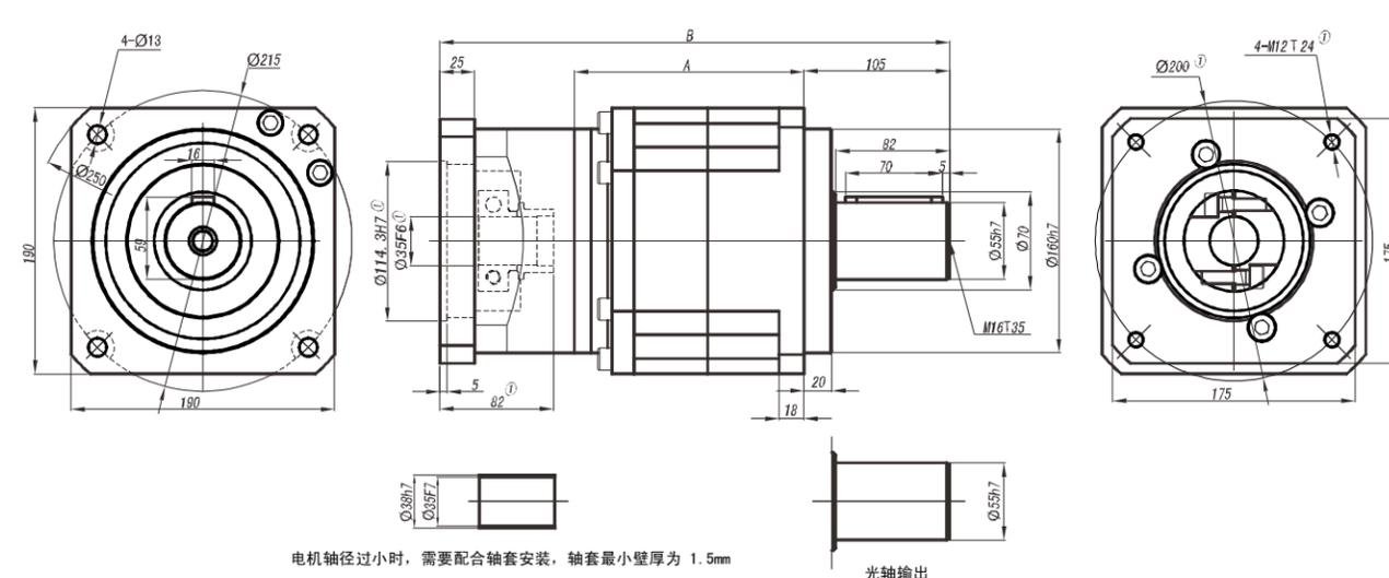
电机轴径过小时, 需要配合轴套安装, 轴套最小壁厚为 1.5mm
