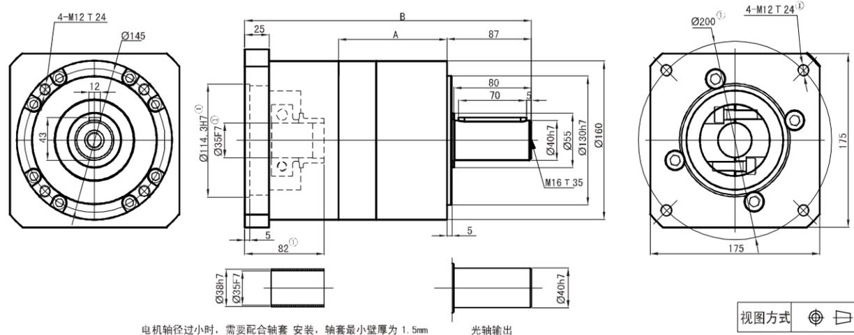
电机轴径过小时, 需要配合轴套 安装, 轴套最小壁厚为 1.5mm
